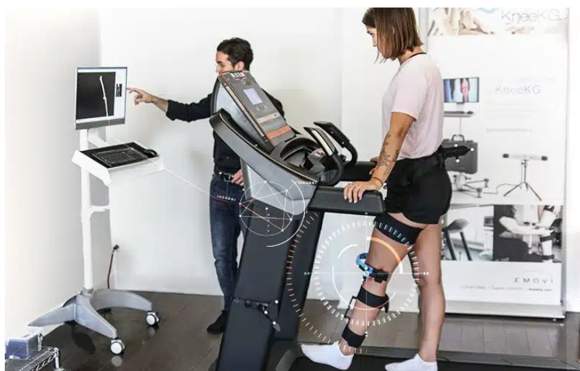
FIGURE 1.10. L'exosquelette du KneeKG [47].
